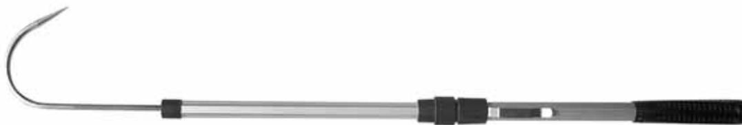
Багорик телескопический, алюминиевый, 2-х коленный. Соединение фиксируется с помощью поджимной пластмассовой гайки. Рукоятка выполнена из ударопрочного пластика. Крюк-поддев имеет резьбовое соединение с верхним коленом
